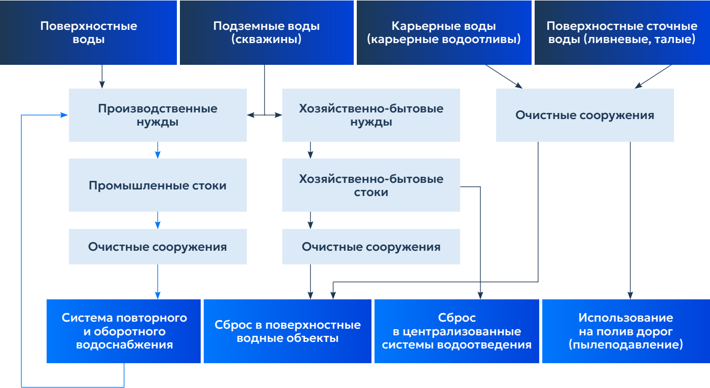
Схема движения воды УК «Кузбассразрезуголь»
